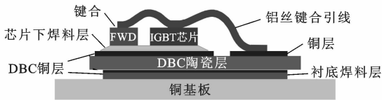
图 1 IGBT 模块分层结构
