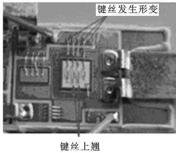
图 6 多根键合引线翘曲
